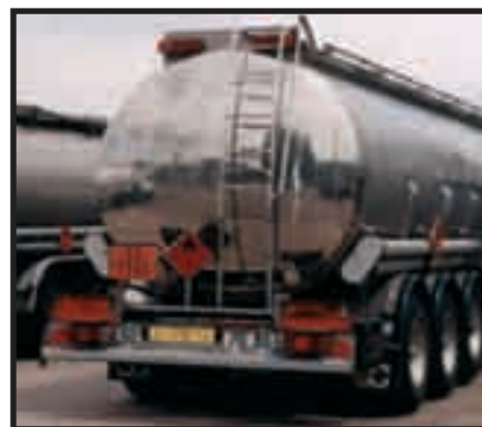
Camion citerne de transport de matières dangereuses. On remarque la présence des plaques de signalisation (panneau orange et panneau pictogramme à l'arrière et sur le côté du véhicule)
